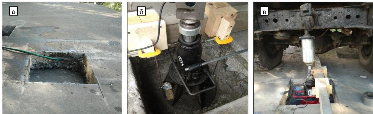
Рис. 3. Проведение штамповых испытаний земляного полотна из ЗШС:
